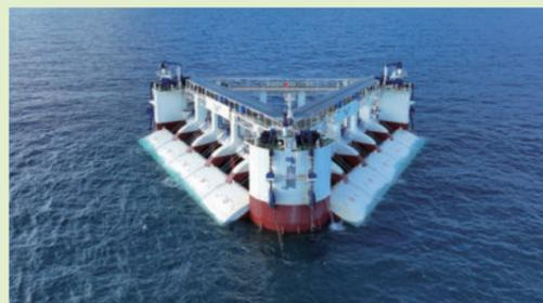
△承保兆瓦级漂浮式波浪能发电装置项目
